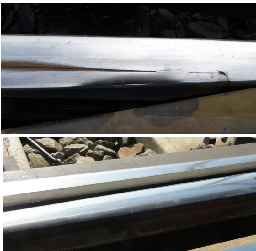
Obrázek 8 – Převalky a kontaktně únavové vady na hrotu
